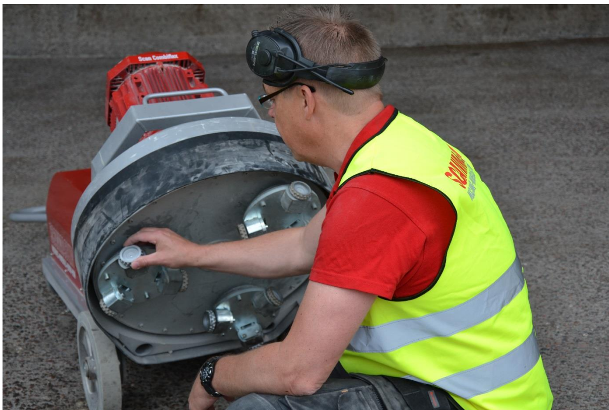
Figur 2.8 Undersidan av Scan Combiflex 650 med tre sliphuvuden (Foto: Y Edwards)
