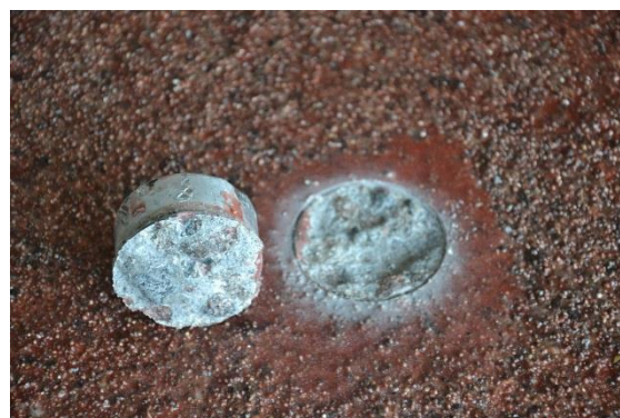
Resultat med 100 % brott i betongen
