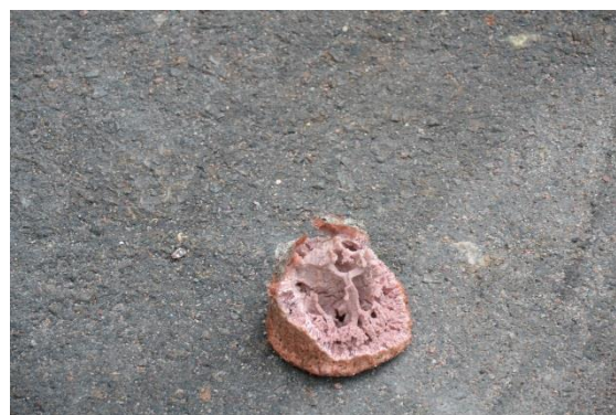
Figur 2.18 MMA-primer ska inte hällas i fuktigt hål (Foto: Y Edwards)
