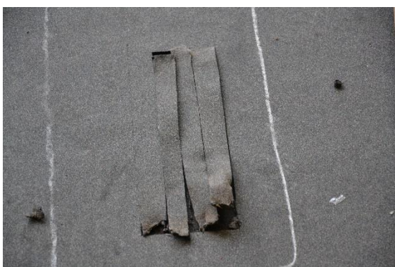
Figur 2.22 Rivprov görs och provstället lagas därefter (Foto: Y Edwards)
