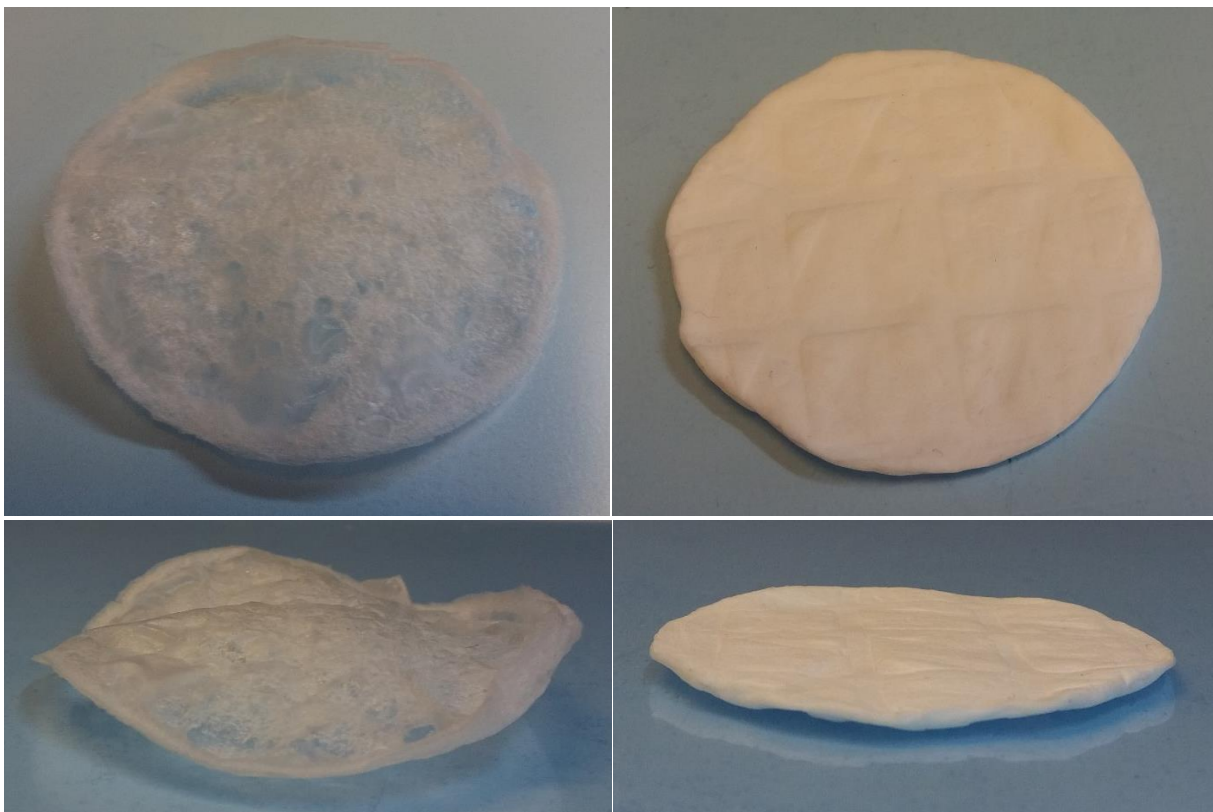
Figur 2. Till vänster: filter regenererat i värme och torkat till torrt tillstånd. Till höger: filter regenererat i etanol och torkat till halvtorrt tillstånd.
